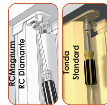
Fissare la testata superiore al soffitto (vedere punto 2).
