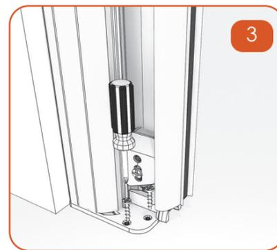
Posizionare e fissare la testata a terra.
