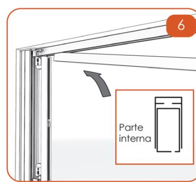
Posizionare la parte interna della guida telescopica nel profilo esterno della guida telescopica.
