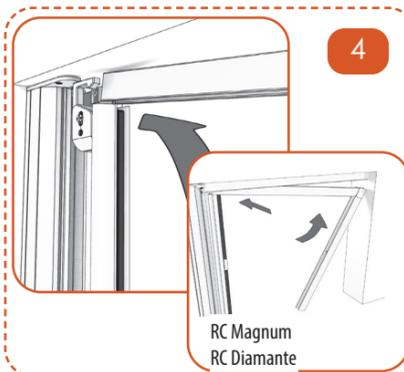
Posizionare il profilo esterno della guida telescopica.
