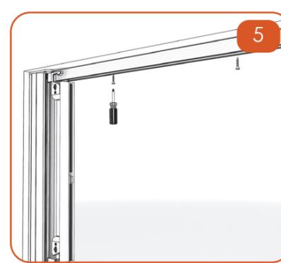
Fissare al soffitto il profilo esterno della guida telescopica.
