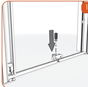
Posizionare le due guide inferiori, di seguito fissare il reggi guida a terra.
